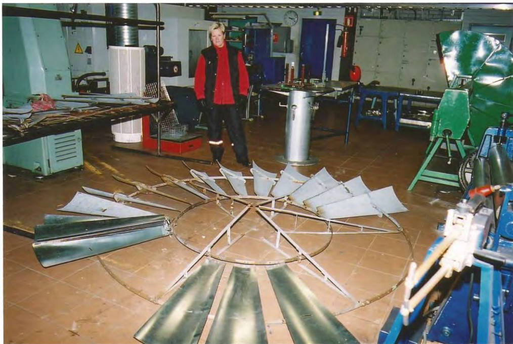
Tuulimoottori kunnostettiin Pohjois-Karjalan Ammattiopiston levyseppä-hitsaaja-linjalla Nurmeksessa. Peltitöiden valvojana oli opettaja Sirpa Mauranen (taustalla) ja koneiston kunnostuksen valvojana lehtori Erkki Damsten.
